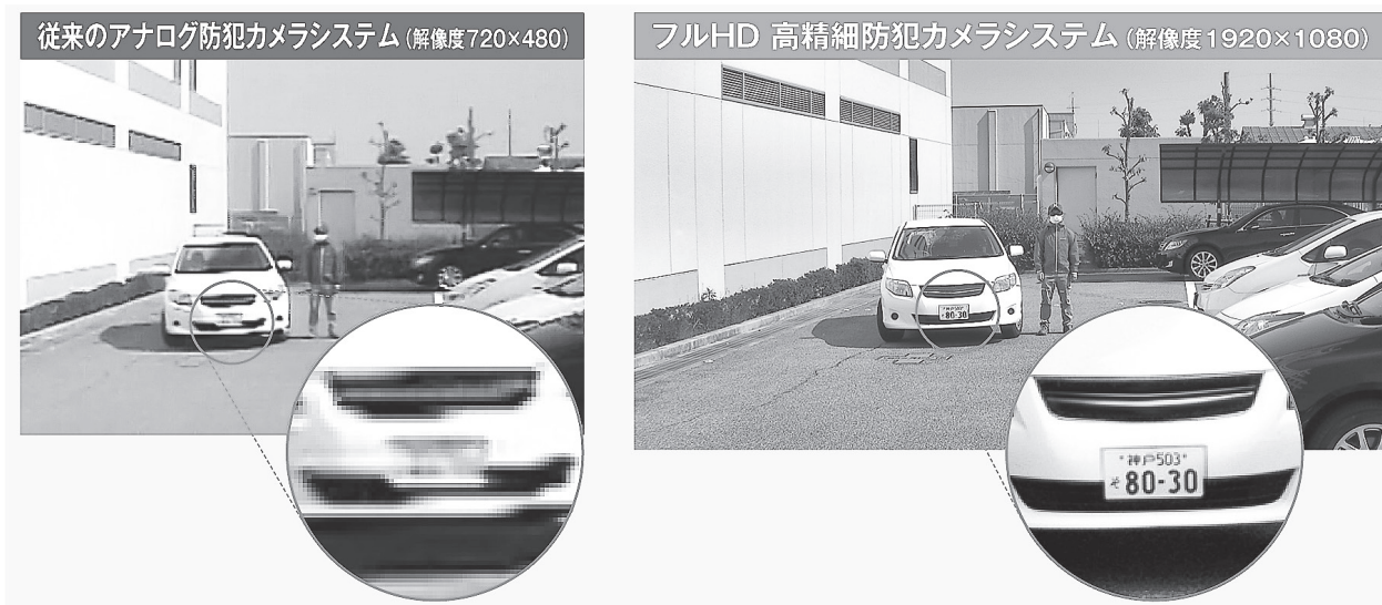
図1 アナログカメラとHD-SDIカメラの画像比較
