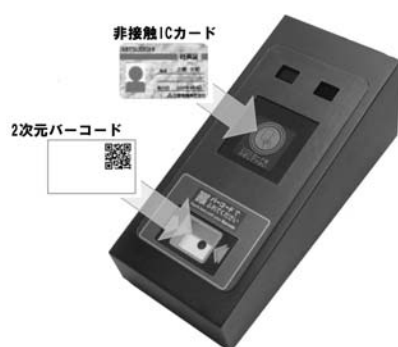
図2 二次元バーコード対応（ハイブリッド）認証端末
