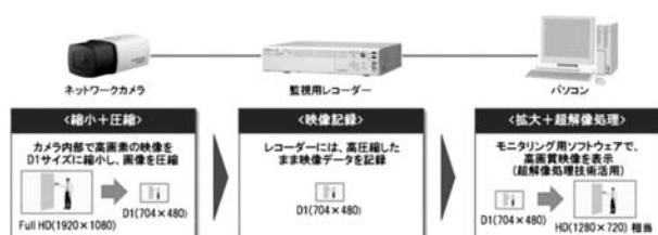
図3 映像監視システム構成図
