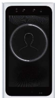
顔認証装置 寸法:92W×163H 日本コンピュータビジョン株式会社製
