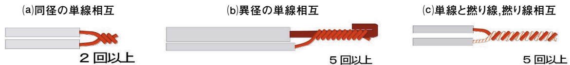
図6-3 芯線の捻り合せ（直接接続）
