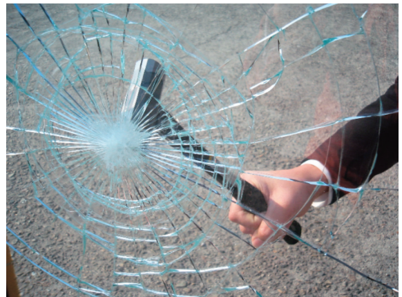
防犯フィルムを貼ったガラスを、ハンマーで叩いても貫通しにくく、手を入れられるだけの穴を開けるのに時間がかかるし、大きな音が出る。
