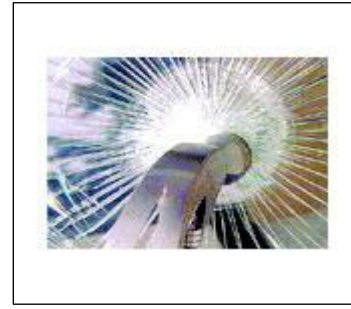
写真 2.7 ハンマーでも割れない例 (防犯フィルム)
