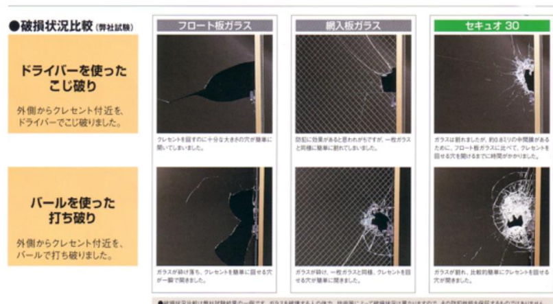
写真 4.2 防犯合わせガラスと一般的なガラスの割れ方の違い
