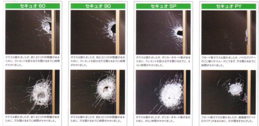
写真 4.3 防犯フィルムを使用した場合のガラスの壊れ方
